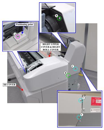
Figure 3-22. Removing the RIGHT UPPER COVER & RIGHT ROLL COVER
